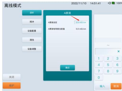
正常吸取 AB 液，待《A 原液电导度值》稳定后，点击《A 原液设定》值，完成 A 原液校正。
