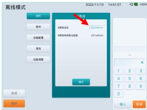
正常吸取 AB 液，待《B 原液电导度值》稳定后，点击《B 原液设定》值，完成 B 原液校正。
