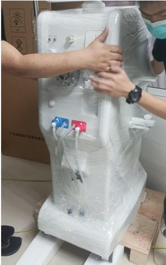
**注：**最好二个人搬运机器，一人在前控制速度，一人在后推动设备。
