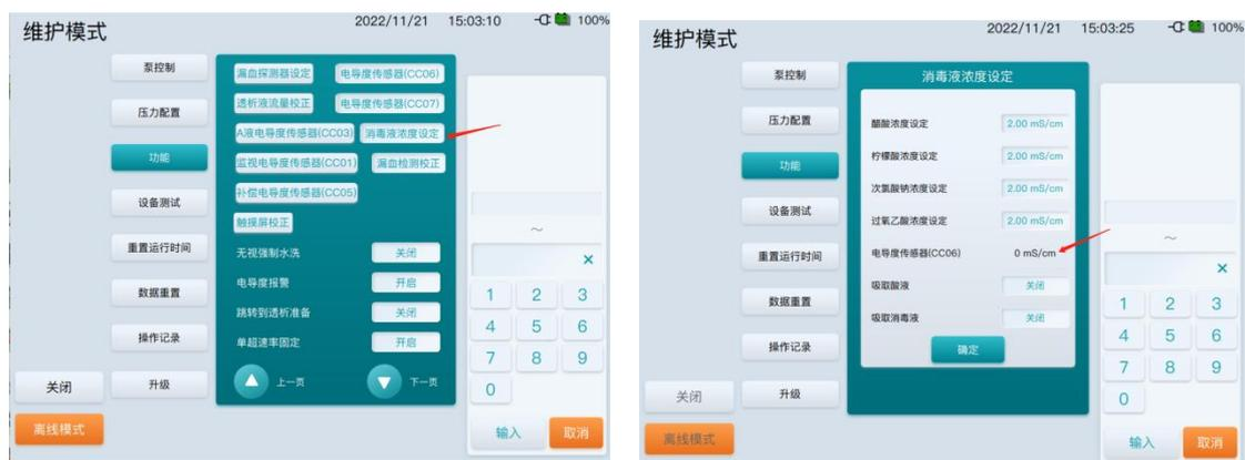
正常进行热水洗，观察电导度传感器 CC06 值，当电导度传感器 CC06 值达到最大值后，将记录的最大值到《柠檬酸浓度设定》值，点击《确认》键，完成柠檬酸消毒液浓度设定。
