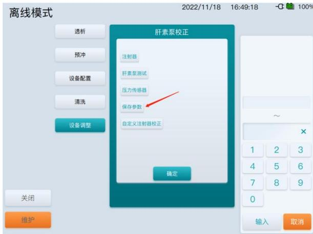
点击《保存参数》，提示“请确认是否将当前参数写入泵组件”，点击《确认键》保存校正参数。
